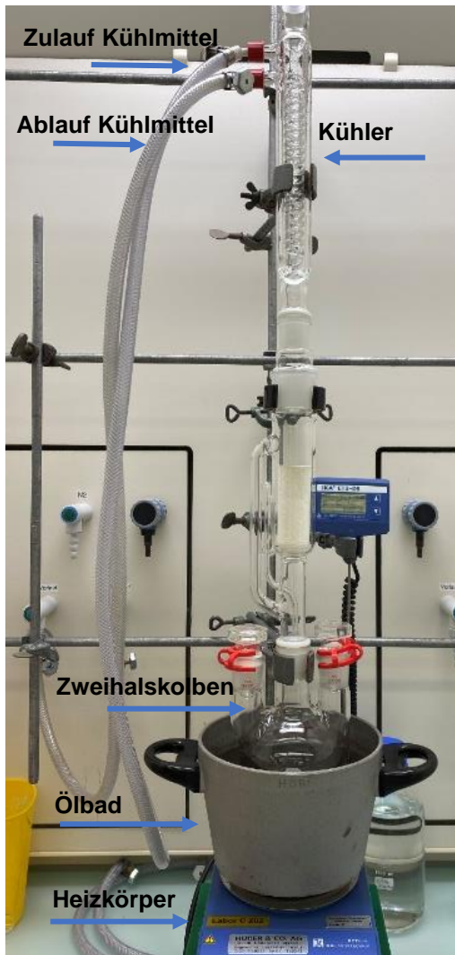
Abbildung 7: Aufbau der Soxhlet-Extraktion mit Soxhlet-Aufsatz, Kühler, Zweihalskolben, Ölbad und Heizkörper und Thermometer. Quelle: Foto wurde selbst während der Extraktion am 03.05.2023 aufgenommen und beschriftet.
